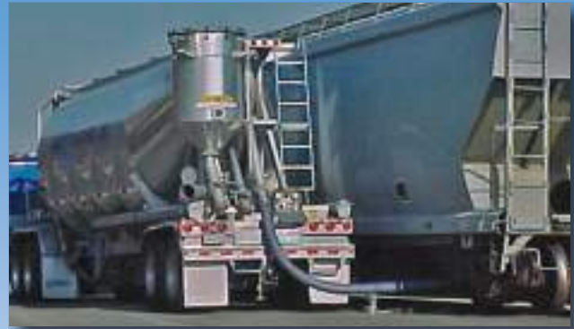
Manguera metalica para descarga de materiales a granel desde tolvas.
